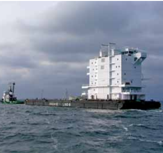
Deckshaus auf Ponton von Schleppern gezogen
